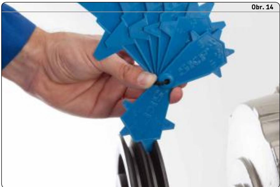
Obecná rada je zběžně prohlédnout řemenice při každé výměně řemenu, ale podrobněji zkontolovat a případně vyměnit při každé třetí výměně řemenu. Použijte měrku SKF pro řemenice ke kontrole opotřebení řemenic (→ obr. 14).
